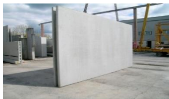
Dinding partisi pracetak
